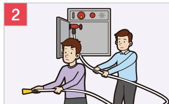
为了不使管子向外扭曲，将管子拉长至着火的地方，抓住喷嘴（管窗），采取消防姿势。
