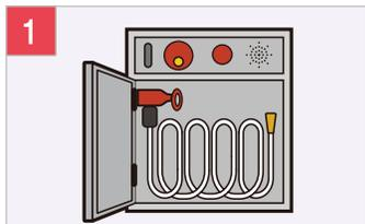
2人中一人先打开装置消防栓的门，确认管子和喷嘴是否连接。
