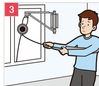
3 将缓降机的带子系至胸部高度。
