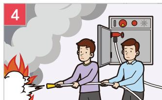
转动喷嘴的末端，调节水量进行灭火。
